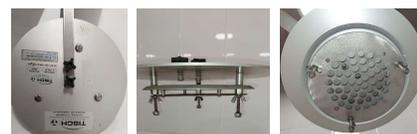
Figura 2: Muestreador pasivo de aire PAS-DD
